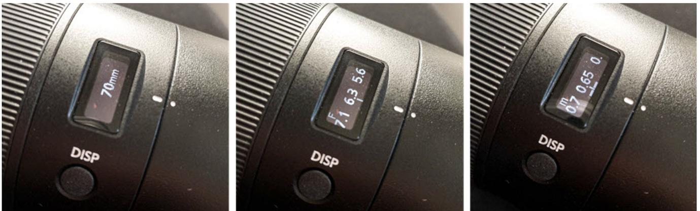
Afficheur OLED du NIKKOR Z 70-200 mm f/2.8 VR S : focale, ouverture, distance de mise au point
