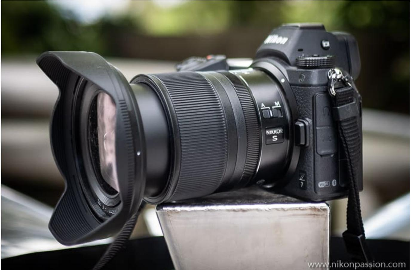
Comprenez aussi par là que du côté de l'ergonomie il faudra vous contenter du minimum syndical : une bague de zoom, une bague de mise au point, un commutateur AF/MF, aucune stabilisation optique (*puisque les boîtiers auxquels il se destine sont stabilisés*) et puis basta.
